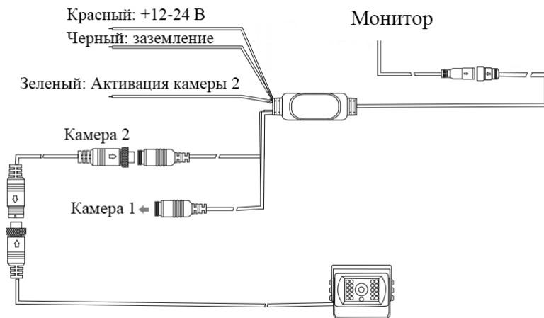
Для автоматического включения камеры заднего вида при включении задней передачи используйте вход CH2.
